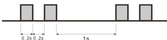
Fig 17 ALM LED 閃爍範例 (過載保護: 閃爍 2 次)
